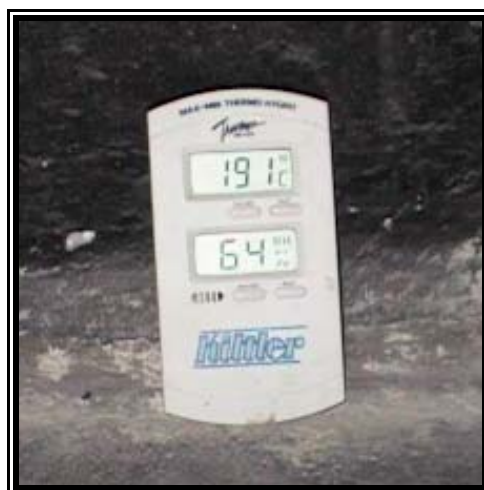
Figura 5.8: Medida de umidade relativa do ar.
