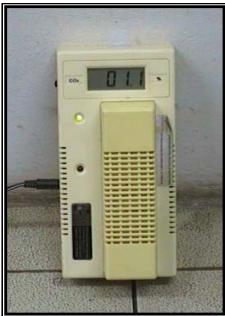
Figura 5.9: Medida de concentração de CO 2 ambiente.
