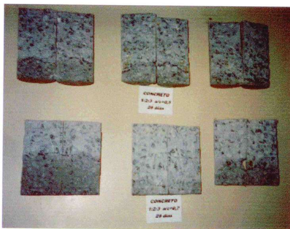
Figura 27 Perfis de distribuição da água nas amostras 5T30 e 7T35
