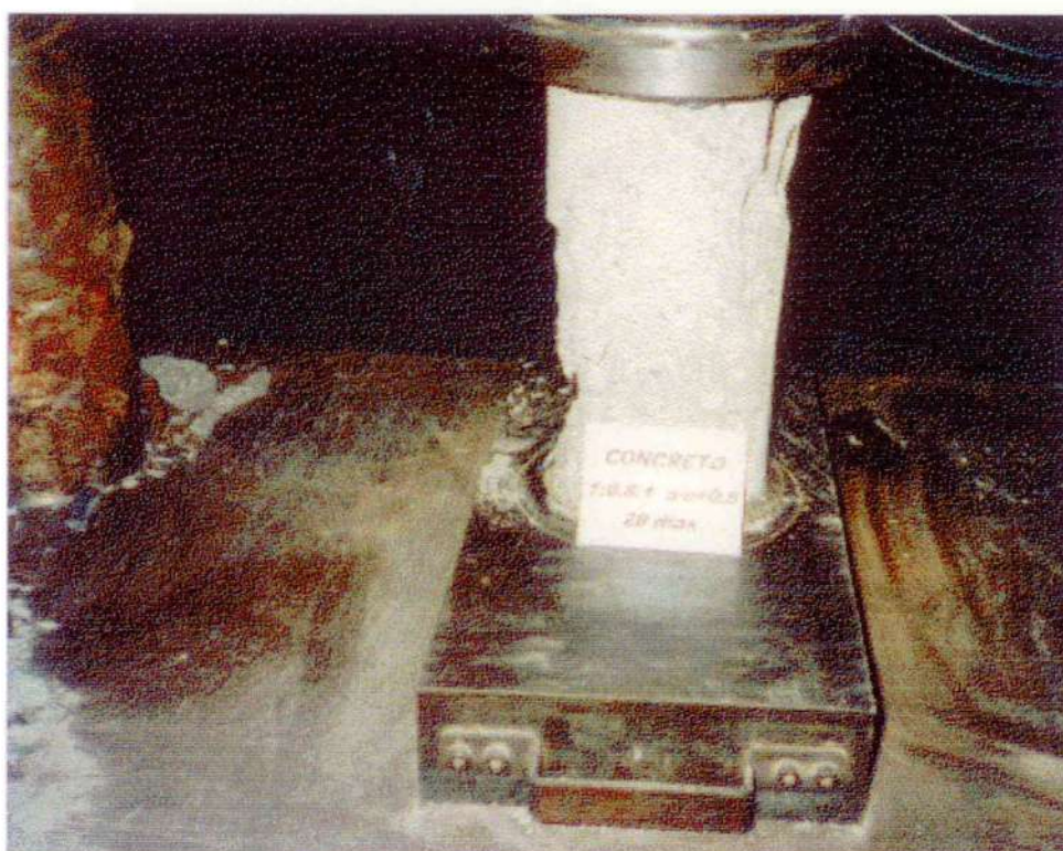
Figura 24 Ruptura de corpo-de-prova do traço 5T55; Tipo colunar
