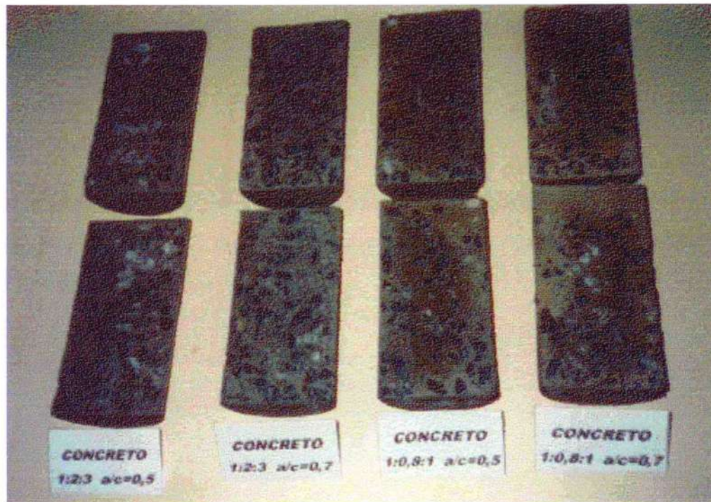
Figura 21 Verificação da homogeneidade do concreto utilizado para os ensaios
