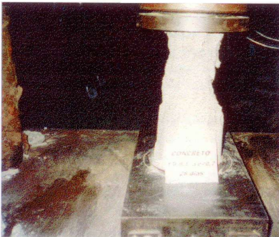
Figura 25 Ruptura de corpo-de-prova do traço 7T60; Tipo colunar
