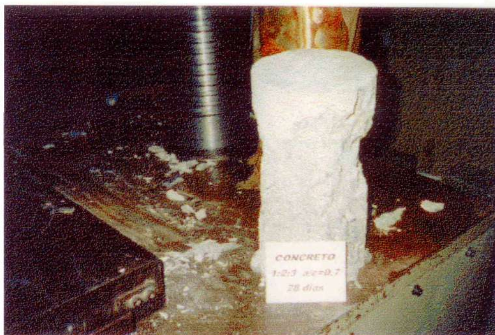
Figura 23 Ruptura de corpo-de-prova do traço 7T35; Tipo cones opostos
