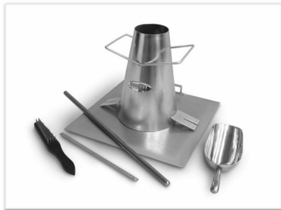
Cone de Abrams Slump-test ou Abatimento
