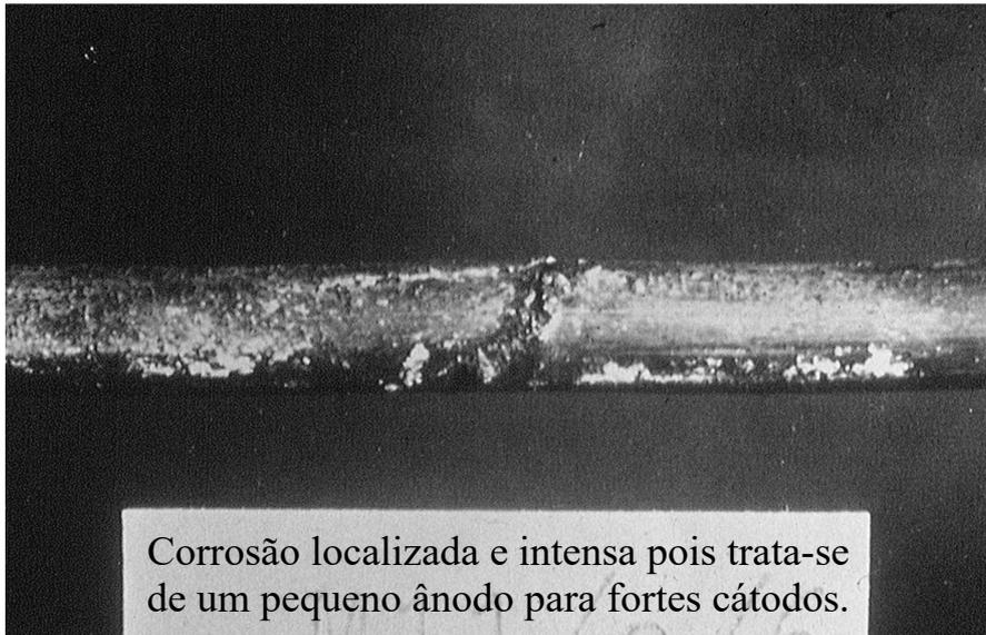
Corrosão localizada e intensa pois trata-se de um pequeno ânodo para fortes cátodos.
