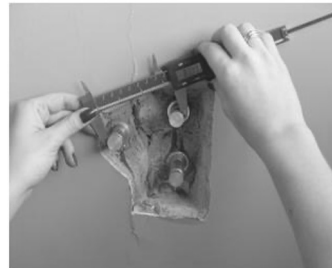
Detalhe da medição da distância entre pinos com auxílio de paquímetro digital.
