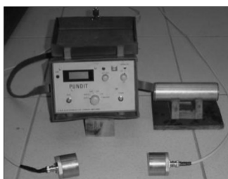
Aspecto do aparelho portátil de ensaio VPU (Arquivo LEME/UFRGS).
