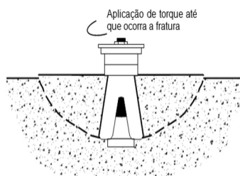
Figura 9 – Procedimento de ensaio de arrancamento ESCOT com uso de luva expansora (CAMPAGNOLO & SILVA FILHO, 2005).
