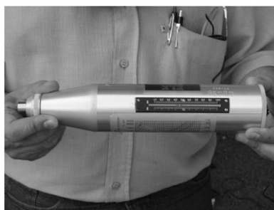
Esclerômetro utilizado para medir a dureza superficial do concreto.
