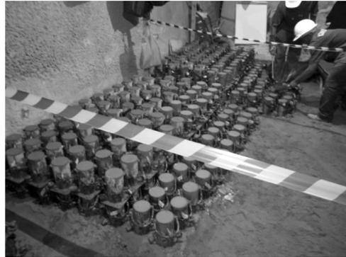
**moldagem de corpos de prova e monitoração de temperatura**
