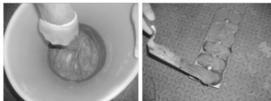
Fig. 4 – Detalhe da argamassa sendo preparada e vertida na fôrma de caixa de ovos.
