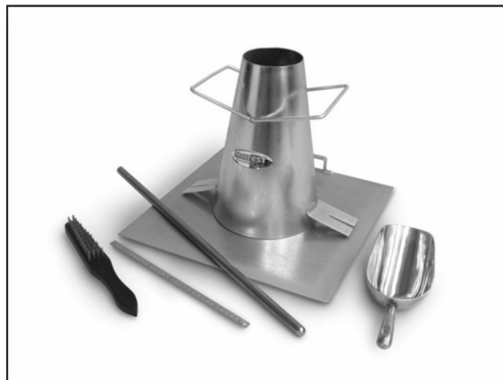
Cone de Abrams Slump-test o Asentamiento
