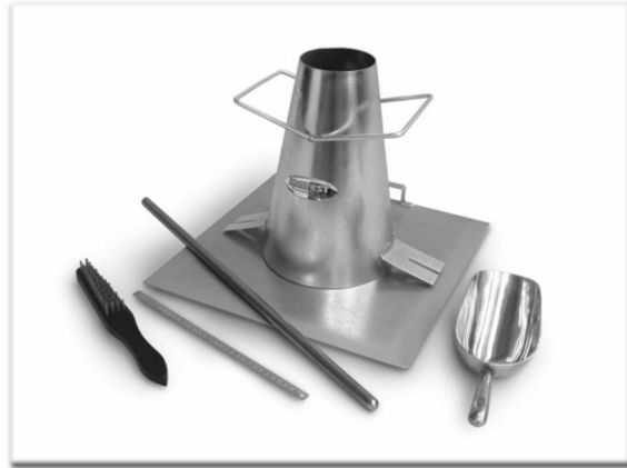
Cone de Abrams Slump-test ou Abatimento
