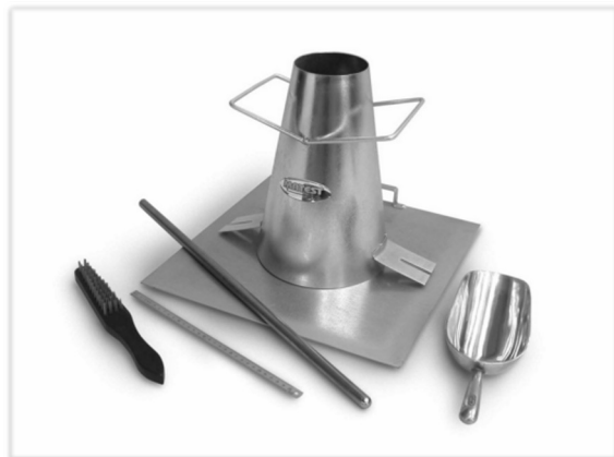
Cone de Abrams Slump-test ou Abatimento
