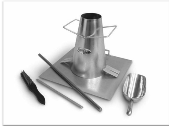
Cone de Abrams Slump-test o Revenimiento
