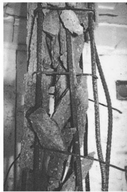
Configuração Convencional de Estribos
