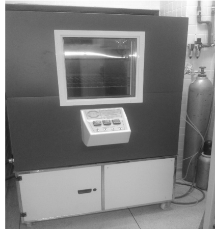
Câmara de carbonatação do laboratório LAME/DCC da UFPR
