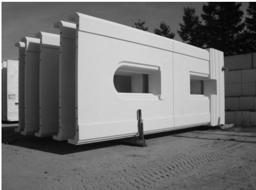
Figura 33 – Painéis e elementos arquitetônicos pré-moldados (em fábrica nos Estados Unidos), sendo: (a) estocagem e (b) exemplo de acabamentos, texturas e colorações
