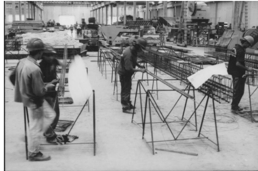
Figura 45 – Produção de pré-fabricados: (a) forma metálica de viga seção I e (b) armação
