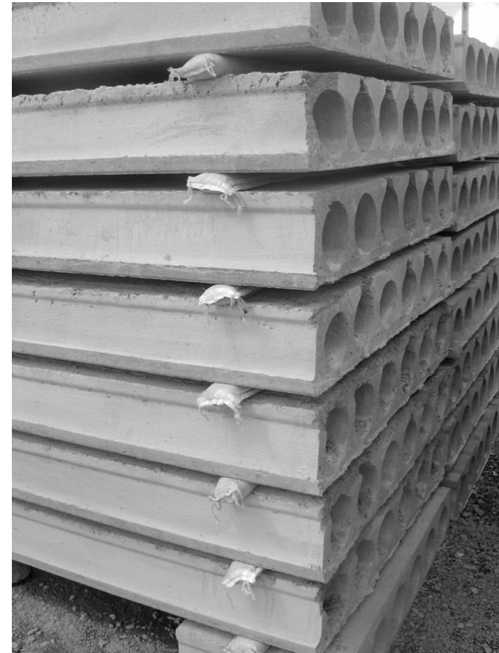
Figura 39 – Armazenamento de laje alveolar em fábrica
