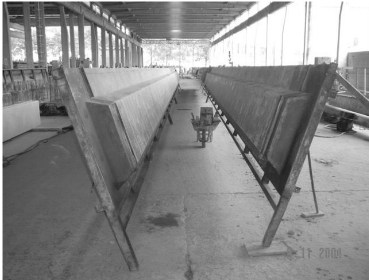
Figura 45 – Produção de pré-fabricados: (a) forma metálica de viga seção I e (b) armação
