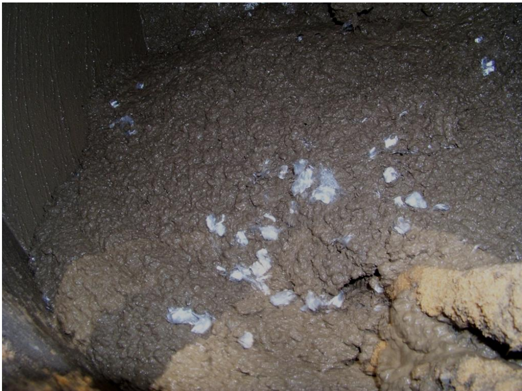
Figura 22: Mistura das Fibras de polipropileno no concreto. (fonte: Autor / data: 28 de agosto de 2012)
