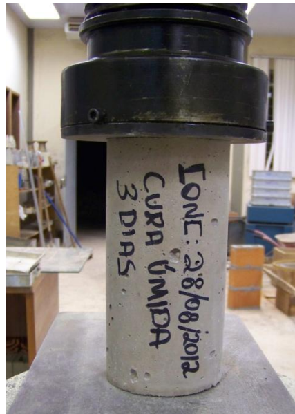
Figura 39: Ensaio para determinação de resistência a compressão. (Fonte: Autor / data: 01 de setembro de 2012).
