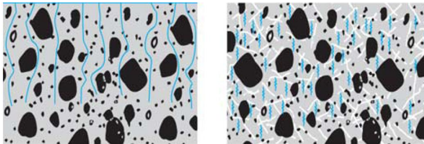
Figura 04 – Mecanismo de ação das fibras de polipropileno n controle da exsudação (FITESA – BOLETIM TÉCNICO Nº 3, 2002).
