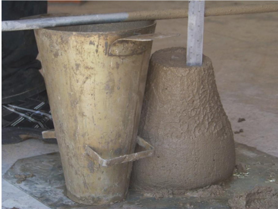
Figura 31: Ensaio de consistência pelo abatimento do tronco de cone. Concreto com fibras. (Fonte: Autor / data: 28 de agosto de 2012).
