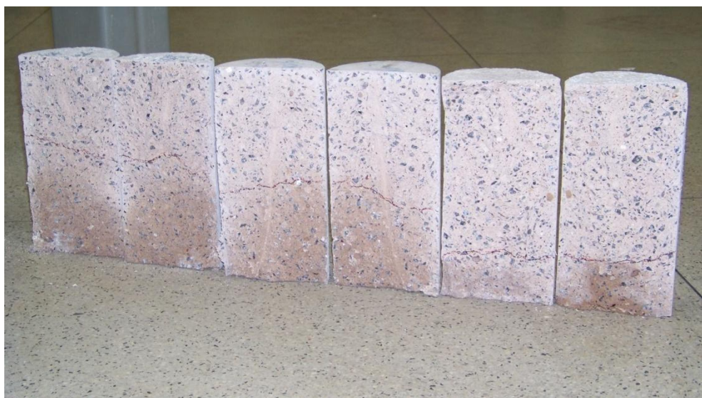
Figura 47: Ilustração das alturas da ascensão de água dos corpos-de-prova para o ensaio de absorção de água por capilaridade.
