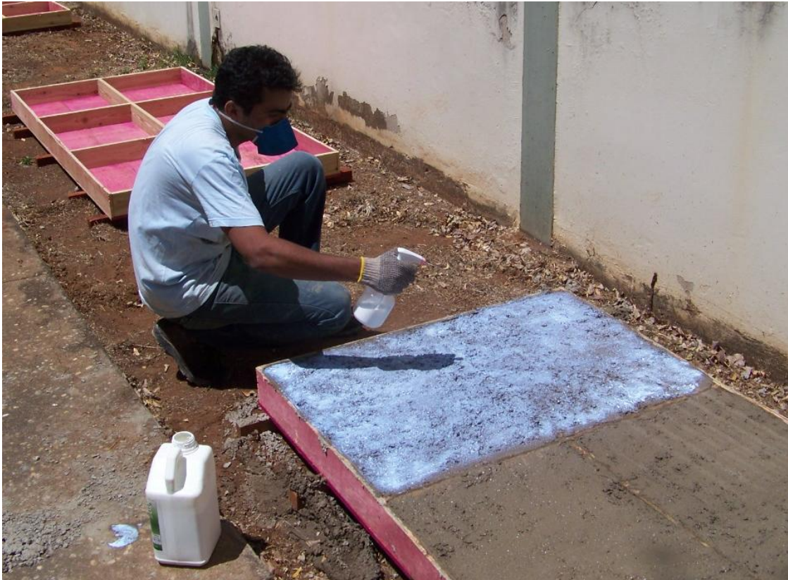
Figura 16: Aplicação do agente de cura química no experimento com placas. (fonte: Autor / data: 28 de agosto de 2012).
