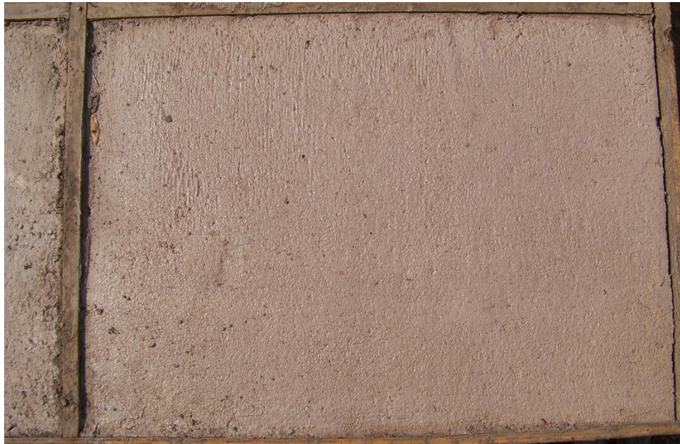
Figura 57 – Concreto com 450g/m 3 de concreto, cura úmida. Sem fissuras. Data: 26 de setembro de 2012. (Fonte: Autor.)
