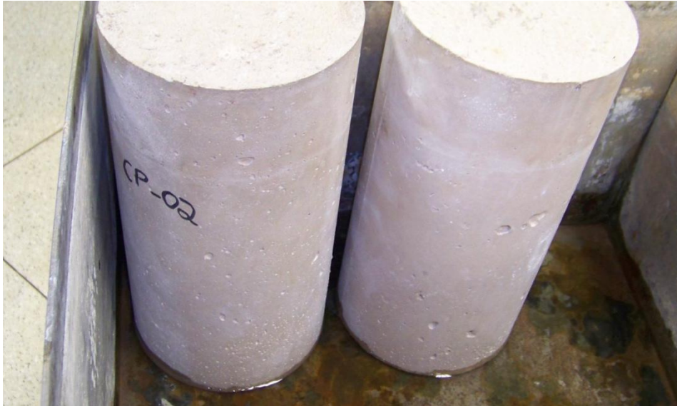
Figura 44: Corpos-de-prova sobre suportes, com nível de d'água (5 +/- 1cm), para ensaio de absorção por capilaridade.
