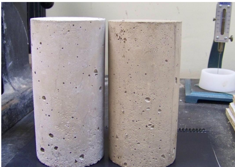
Figura 15: Aplicação do agente de cura química no experimento, corpo-de-prova da esquerda (sem agente) e corpo-de-prova da direita (com agente); (fonte: Autor / data: 29 de agosto de 2012).
