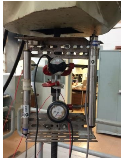
Figura A-2. Transdutores e extensômetros elétricos instalados no EE-RC-20mm-3 com o auxílio de uma canaleta de alumínio. Fonte: Autor
