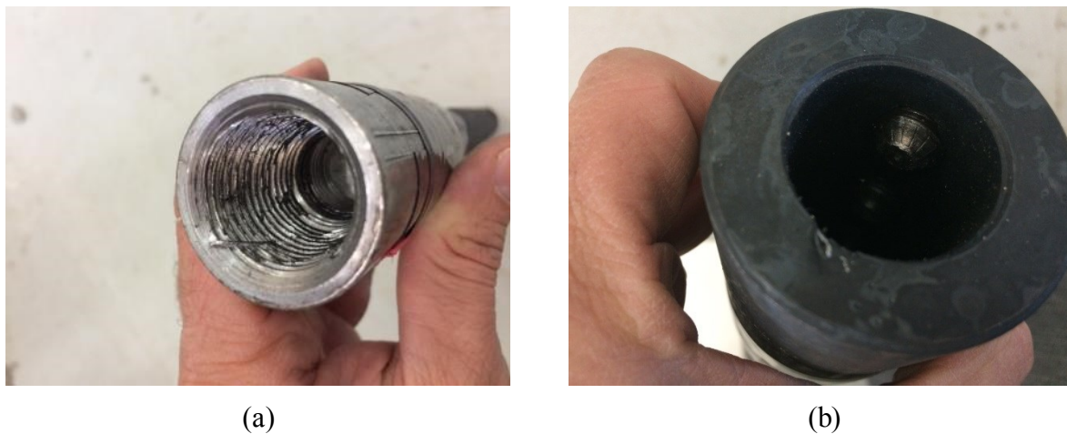
Figura 4-17. Face externa da (a) luva de rosca cônica e (b) luva parafusada pós-arrancamento da barra de aço. Fonte: Autor
