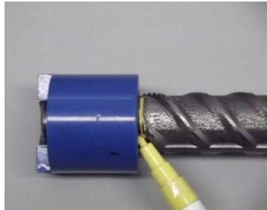
Figura 2-10. Anel calibrador inserido na barra de aço. Fonte: Autor
