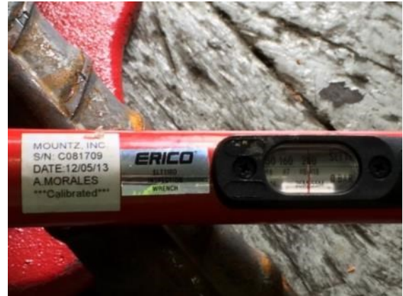
Figura 2-15. Verificação do torque aplicado à luva e barra de aço. Fonte: Autor
