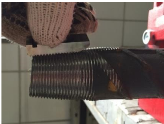
Figura 2-12. Guia colocada sobre a rosca cônica para medir a qualidade dos frisos. Fonte: Autor
