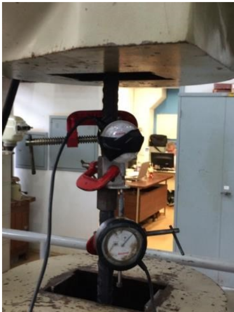
Figura A-1. Transdutores instalados na amostra EE-RC-20mm-1. Fonte: Autor
