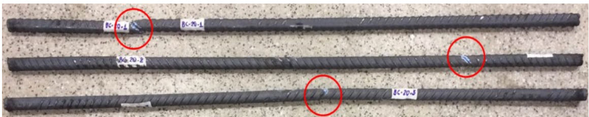
Figura 4-4. Barras de controle de 20 mm após ensaio. Fonte: Autor
