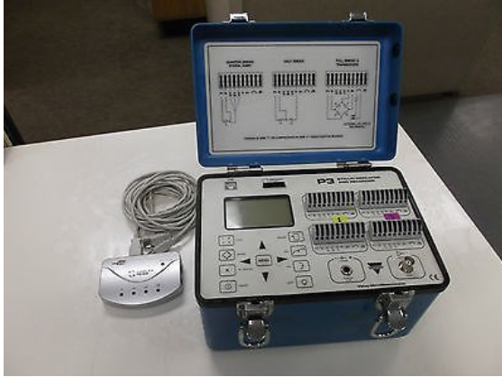
Figura 3-4. Aquisitor de dados das leituras dos extensômetros elétricos.
