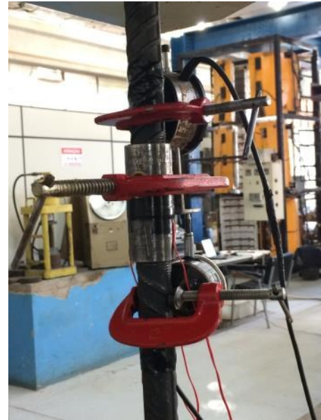
Figura 3-11. Fixação dos transdutores à barra e à emenda mecânica. Fonte: Autor
