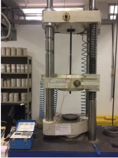
Figura 3-1. Máquina universal de tração utilizada nos ensaios das barras de controle. Fonte: Autor
