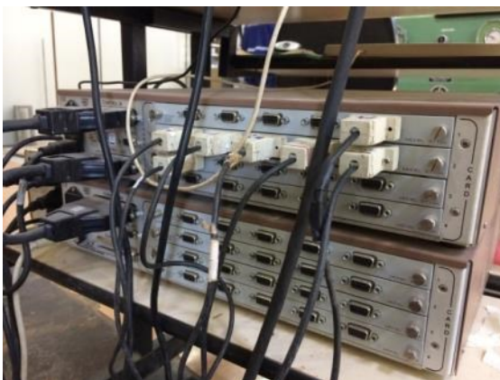
Figura 3-17. Aquisitor de dados das leituras dos instrumentos de medição. Fonte: Autor
