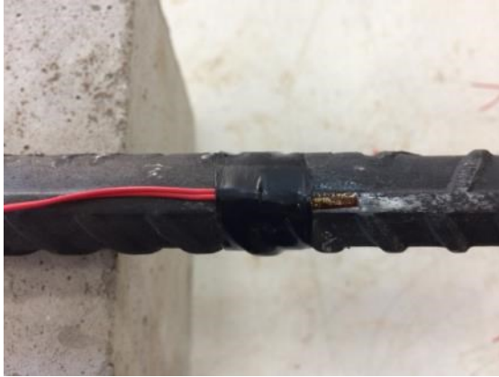
Figura A-3. Extensômetro elétrico colado na nervura da barra de aço. Fonte: Autor
