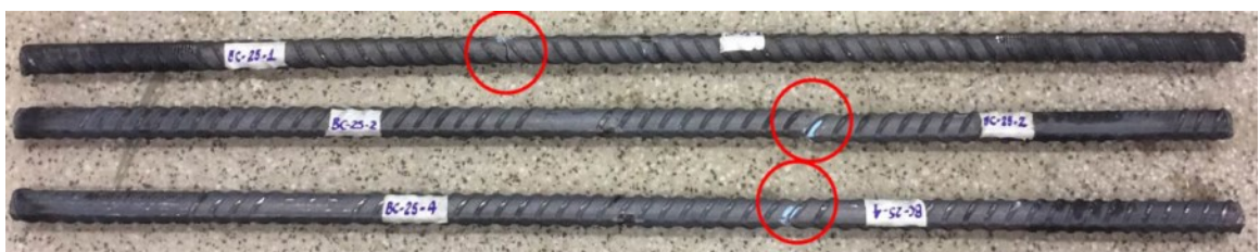
Figura 4-5. Barras de controle de 25 mm após ensaio. Fonte: Autor
