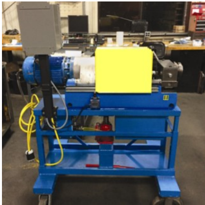
Figura 2-9. Máquina para execução da rosca cônica Fonte: LENTON (2011)
