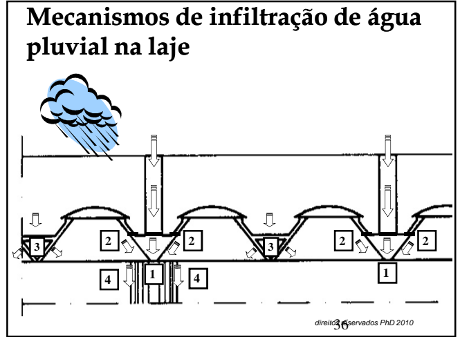
4º MECANISMO: Encontro de vigas cheias com o pilar. Deficiência de estanqueidade da união entre ralo e duto de água pluviais
