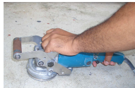
Rugosidade da superfície recém-escarificada, devendo ser lixada
