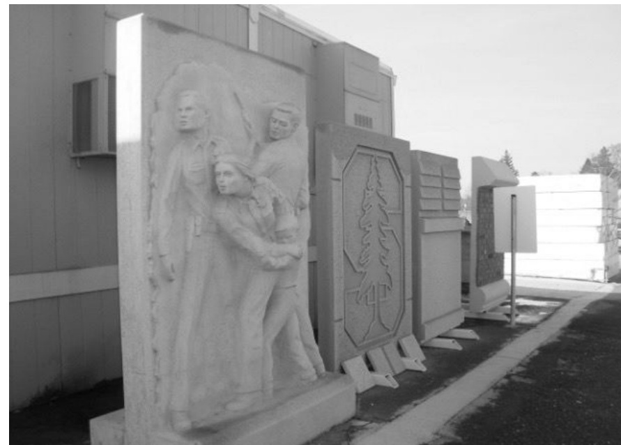
Figura 33 – Painéis e elementos arquitetônicos pré-moldados (em fábrica nos Estados Unidos), sendo: (a) estocagem e (b) exemplo de acabamentos, texturas e colorações
