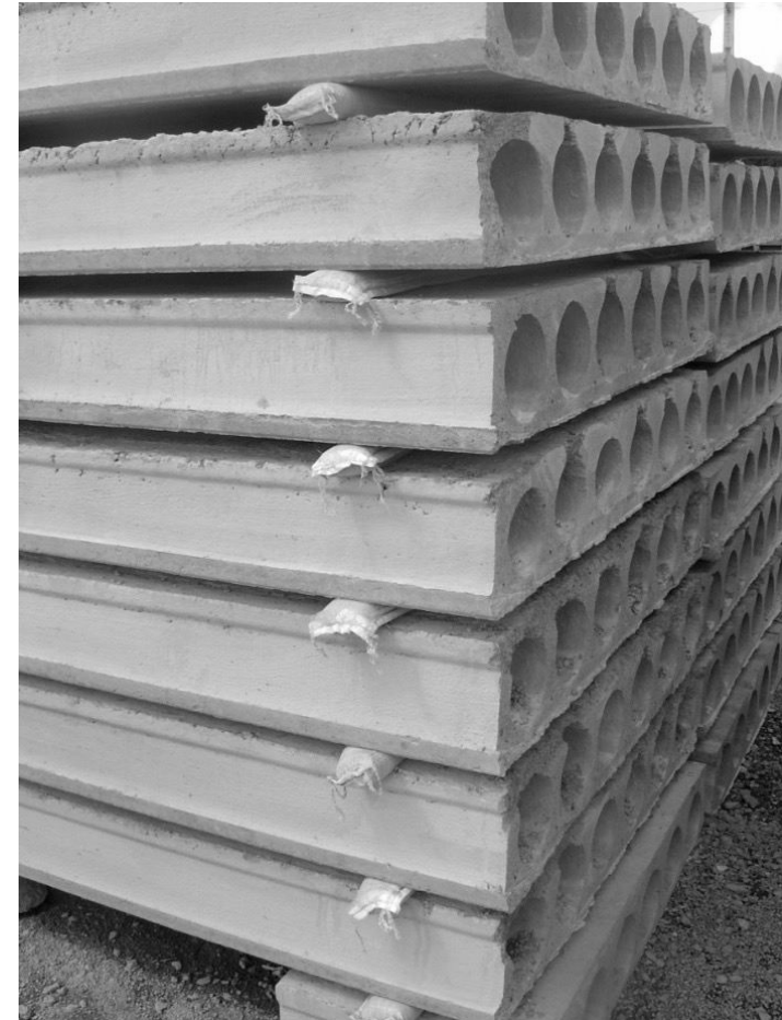
Figura 39 – Armazenamento de laje alveolar em fábrica
