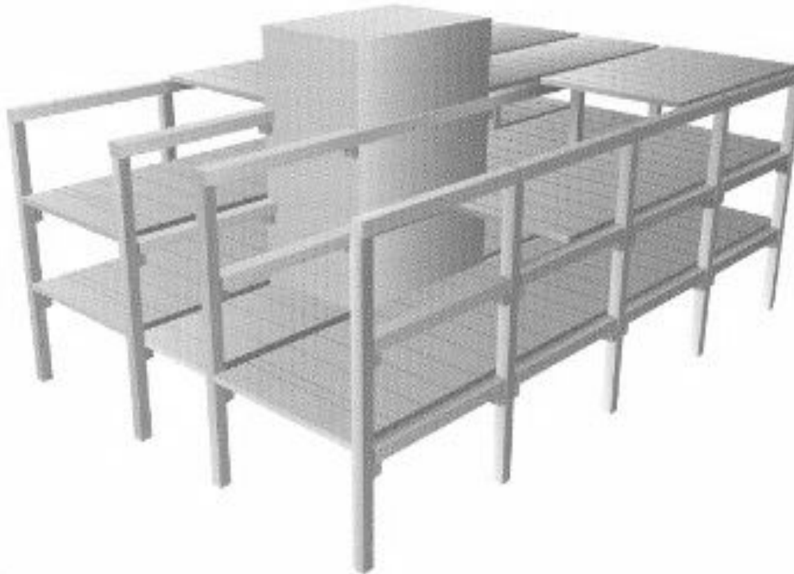
Figura 18 – Sistema estrutural em esqueleto com núcleo rígido (central) (extraído de Van Acker, 2007)
