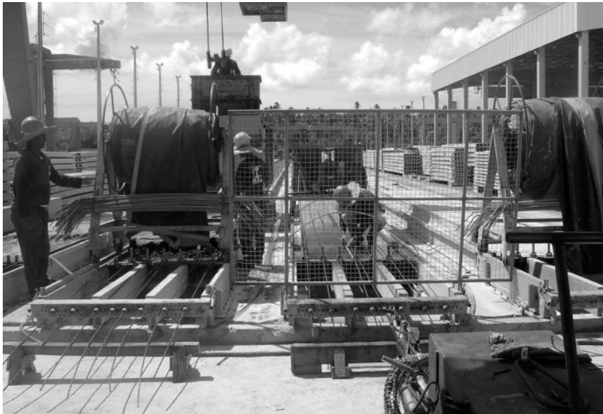
Figura 5 - Cabeceira de protensão em pista de pré-tração – produção de lajes alveolares
