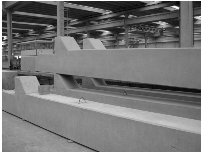
Figura 2: Armazenagem de pilares pré-moldados em instalações industriais
