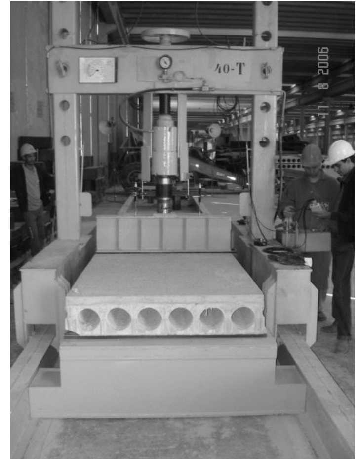
Figura 16 – Ensaio de cisalhamento de lajes alveolares protendidas pré-fabricadas em instalações de fábrica e parceria com o NETPRE/UFSCar
