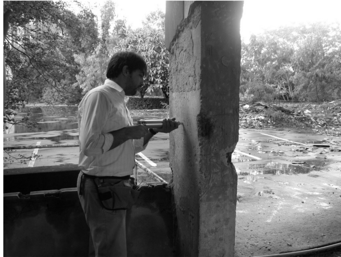
Medição da dureza superficial através de Esclerometria
