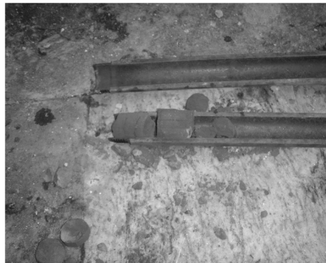
Sondagem a percussão - SPT Standard Penetration Test
