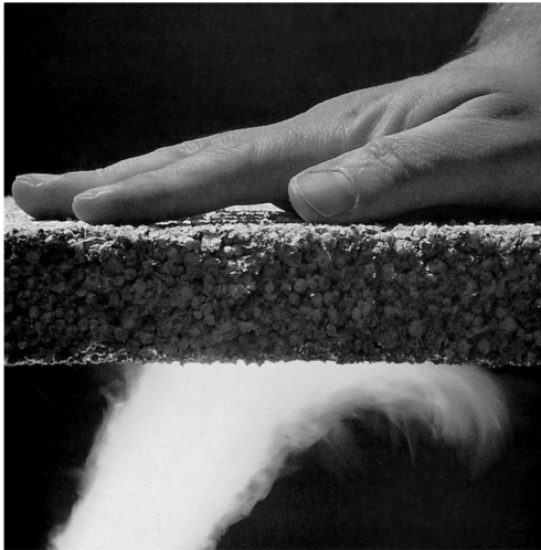
Isolamento térmico e estanqueidade do concreto (Jacobs, 2007)
