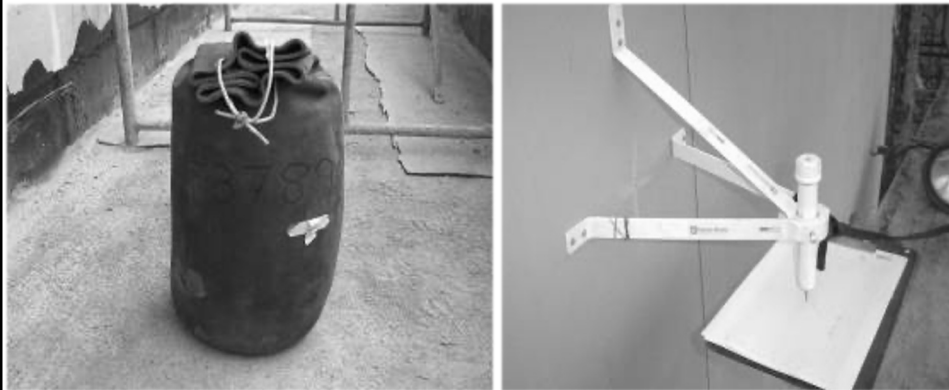
Massa padronizada e dispositivo de registro dos deslocamentos horizontais
