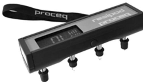
Modelos de sensores para monitorar a resistividade superficial do concreto baseados na técnica dos quatro eletrodos (<http://www.proceq.com>)
