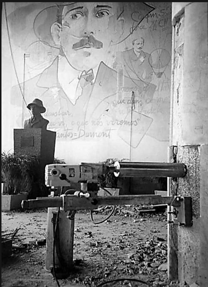
Extração de amostras do concreto de pilares íntegros do saguão
