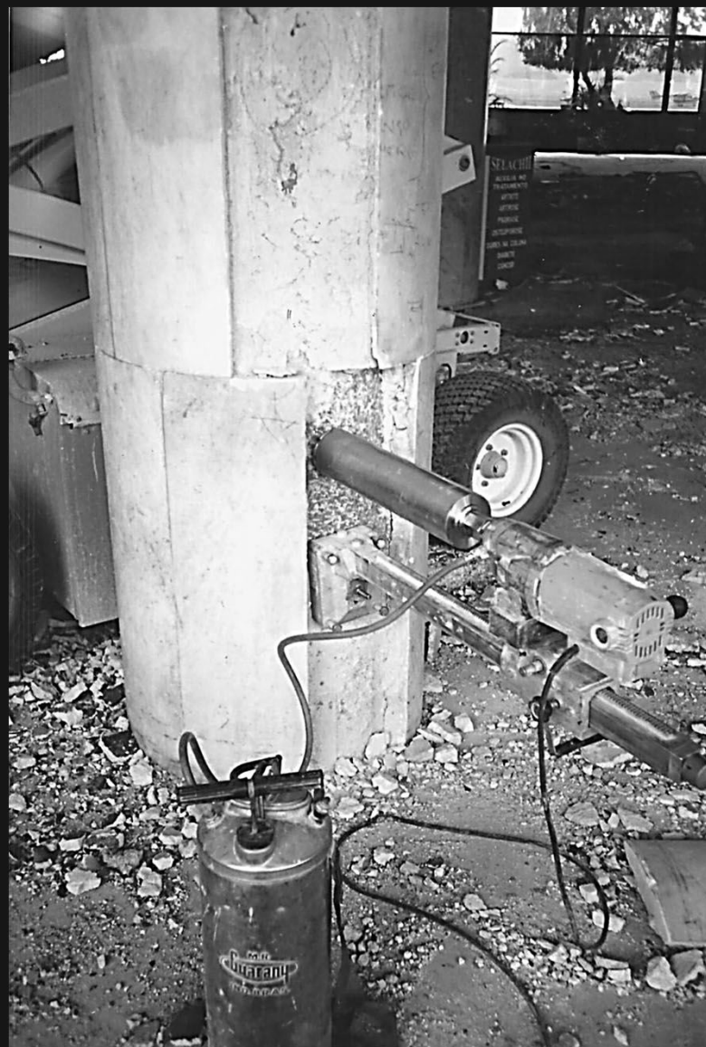
Extração de amostras do concreto de pilares íntegros do saguão
