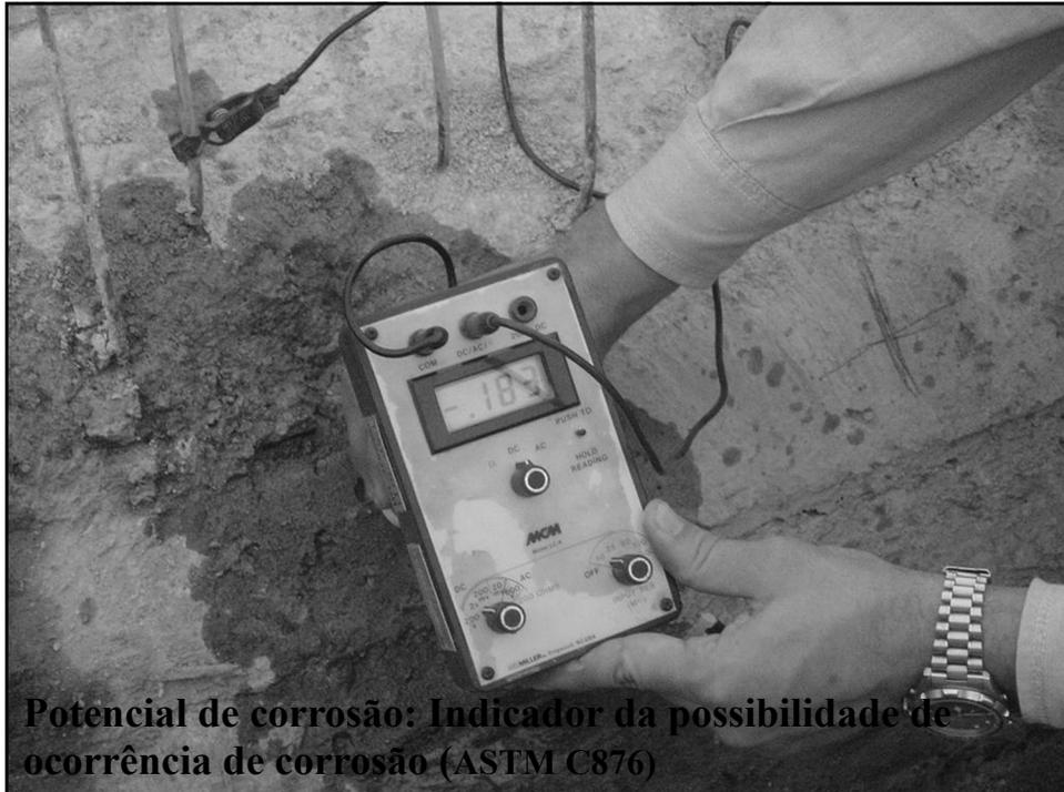
**Potencial de corrosão: Indicador da possibilidade de ocorrência de corrosão (ASTM C876)**
