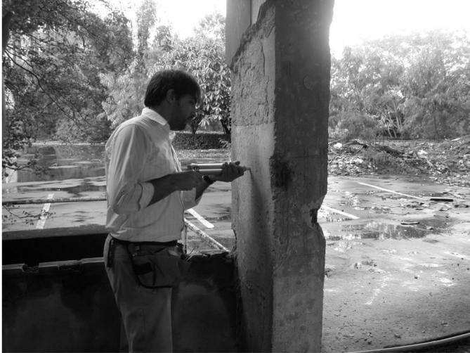
**Medição da dureza superficial através de Esclerometria**
