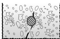
B) Fissuração devida as forças de expansão dos produtos de corrosão
