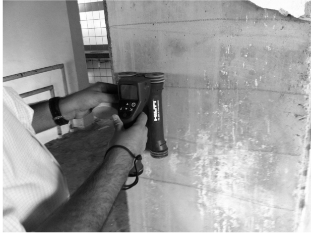
Pacometria de colunas para posição de armadura
