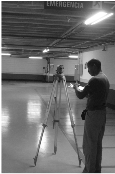
Controle contínuo de deslocamento vertical (recalque) dos pilares P1, P1A e P2
